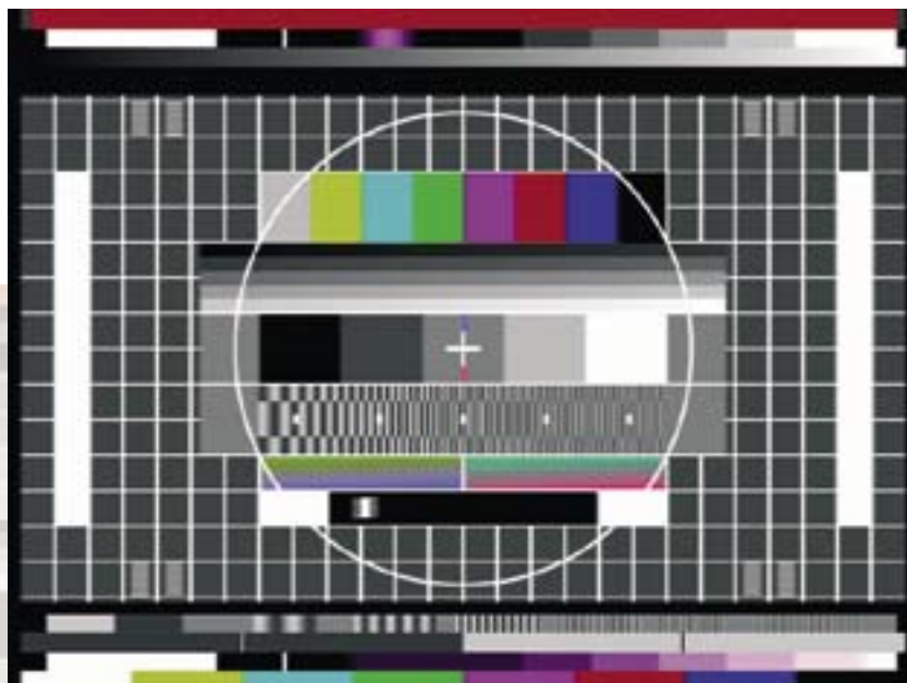
Испытательный сигнал: универсальная испытательная таблица кодека Rohde & Schwarz в формате 4:3
